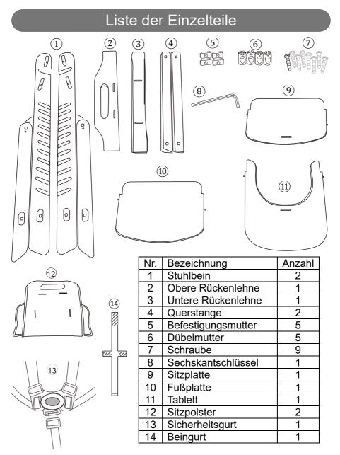
Hinweis: Jeweils eine weitere Befestigungsmutter, Dübelmutter und Schraube sind als Ersatzteile beigelegt und werden nicht für die Montage benötigt.
