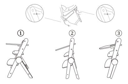
Die Sitzplatte muss auf der obersten Position 1 eingerastet sein, um die Norm EN 14988:2017 + A1:2020 einzuhalten. Für die Fußstütze gibt es 10 mögliche
